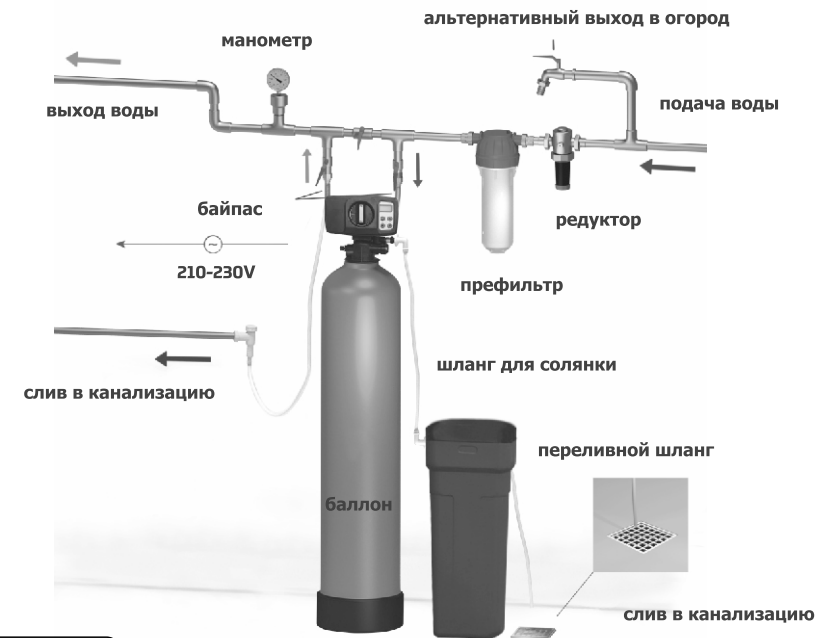
рис.4. Схема подключения двухэлементного умягчителя
